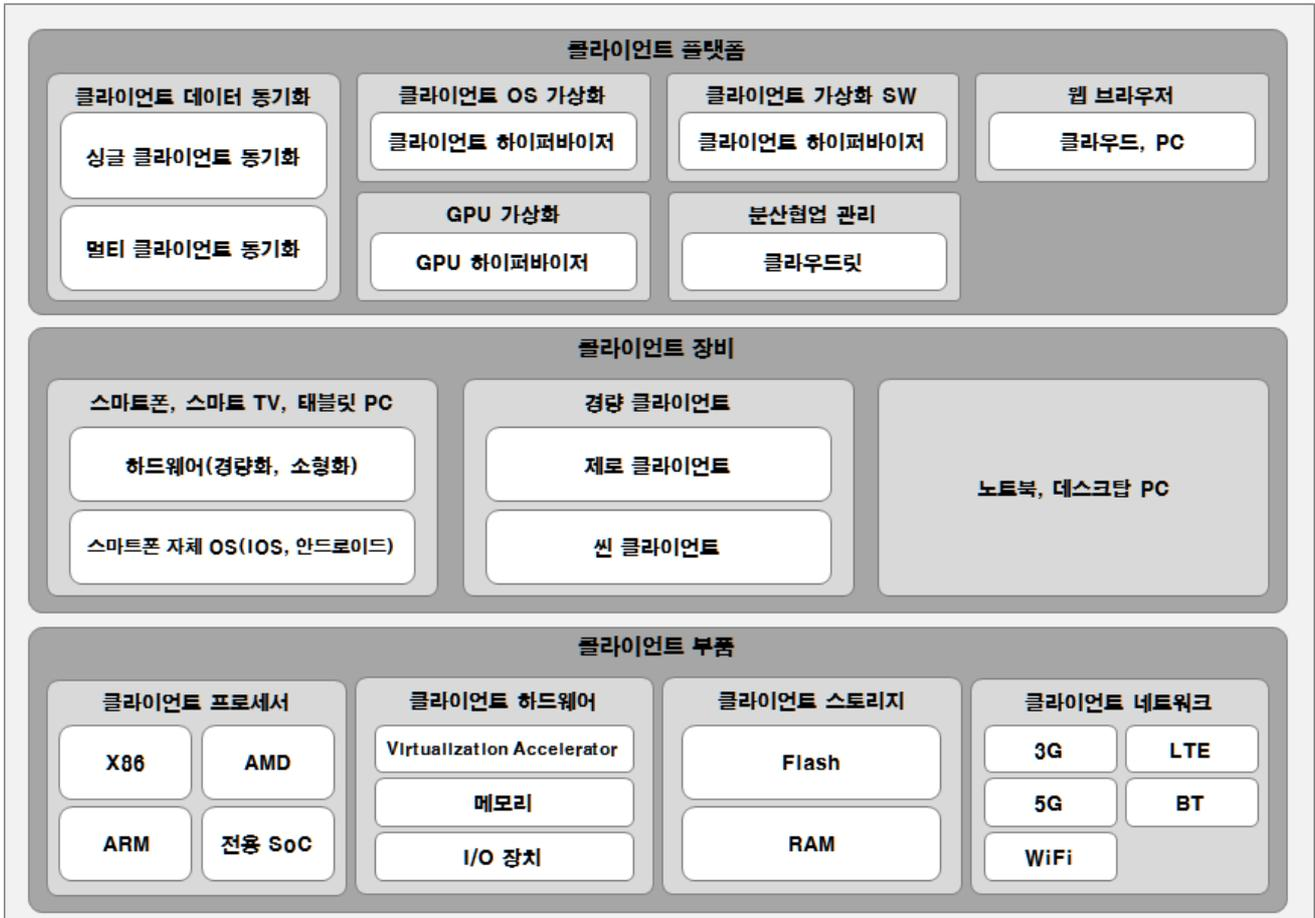
[그림 IV-5] 클라우드컴퓨팅 서비스 단말(CCD) 기술 스택
